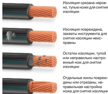
Ошибки снятия изоляции согласно DIN МЭК 60352-2
