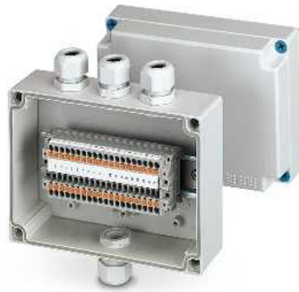
Клеммная коробка с 20 клеммами сечением 2,5 мм 2 с технологией соединения push-in
