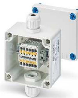
Клеммная коробка с 6 клеммами сечением 2,5 мм 2 с технологией соединения push-in
